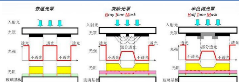
图表19: 平板显示领域不同掩模版工作原理
