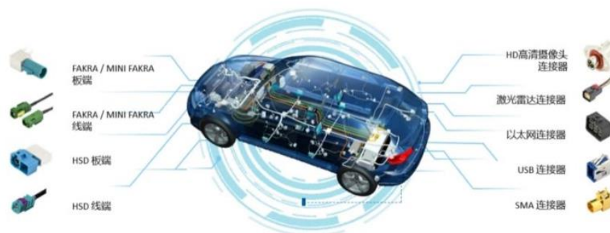
图 11: 高频高速连接器在智能汽车上的应用
