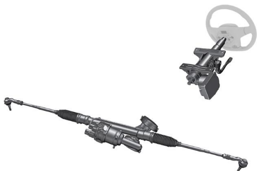
图 12：线控转向系统示意图，方向盘与转向机构之间没有硬连接
