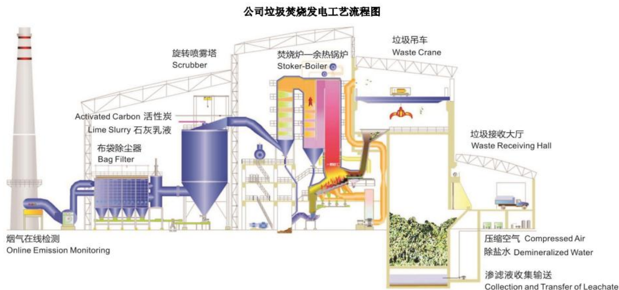
图 3：公司垃圾焚烧发电工艺流程图
