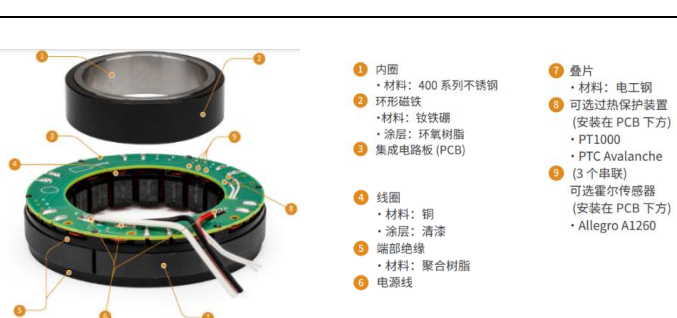
图23：无框力矩电机只包含定子和转子，可输出大力矩
