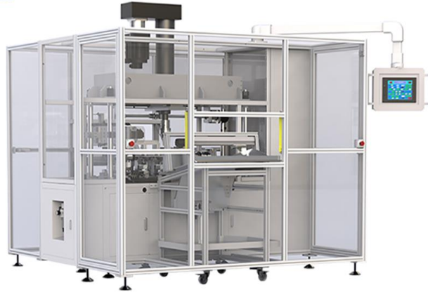
图33：集智股份开发的全自动校直机适用于轴承检测与校直
