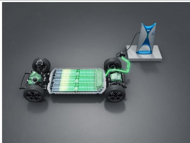
图20：扶摇架构搭载 800V 高压 SiC 碳化硅平台
