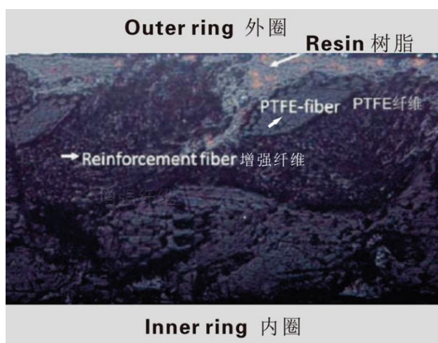
图32：公司研制的新 PTFE 衬垫的横截面图
