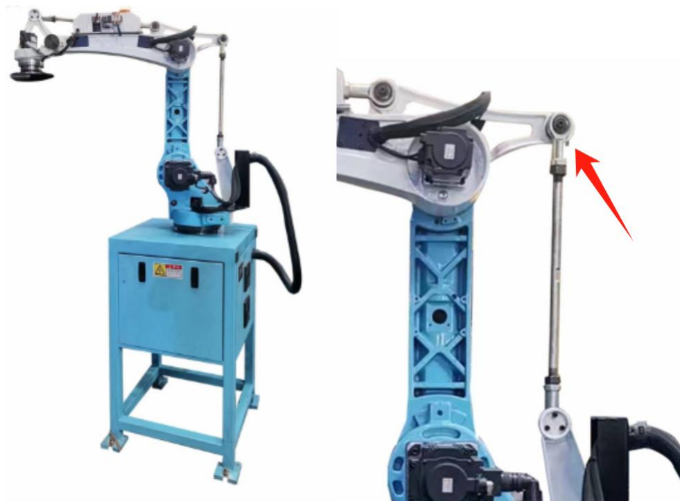
图29：四/五轴关节机械手的连接部位需要用到关节轴承
