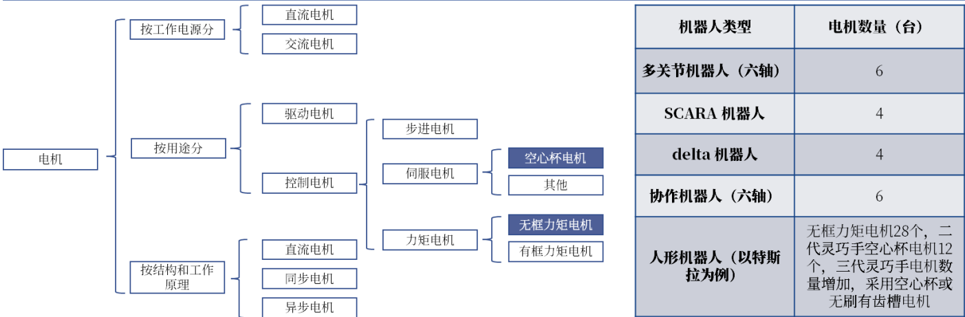
图17：电机分类以及不同机器人对电机的数量要求
