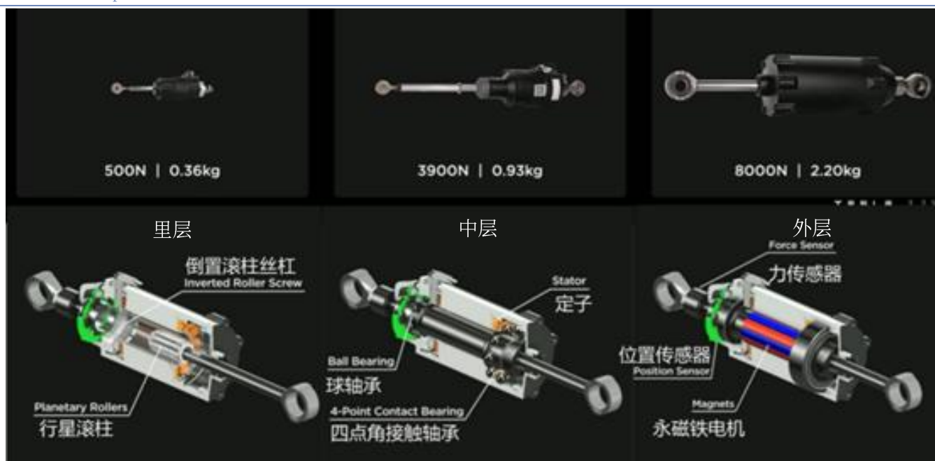
图16: 特斯拉 Optimus 线性关节
