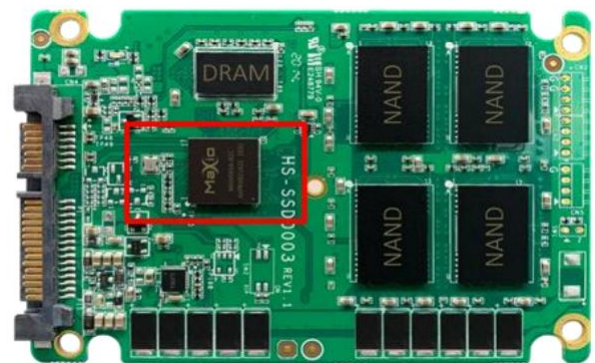
图35：SATA 接口固态硬盘内部构造图
