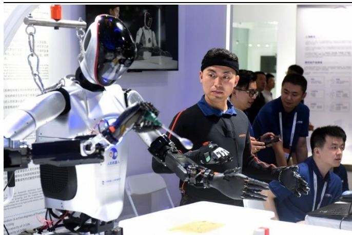
图5：2024 年世界人工智能大会上人形机器人需要吊装辅助
