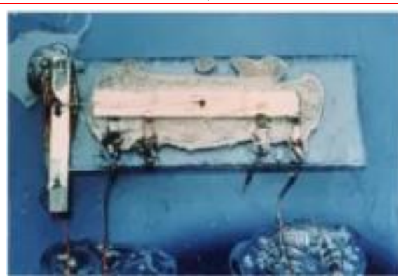
图 15: 基尔比的发明 (世界第一块集成电路)
