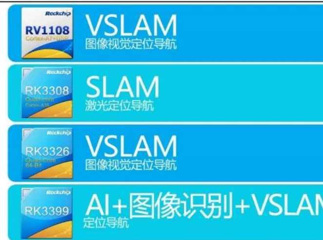
图24：瑞芯微推出的四套扫地机器人芯片级解决方案
