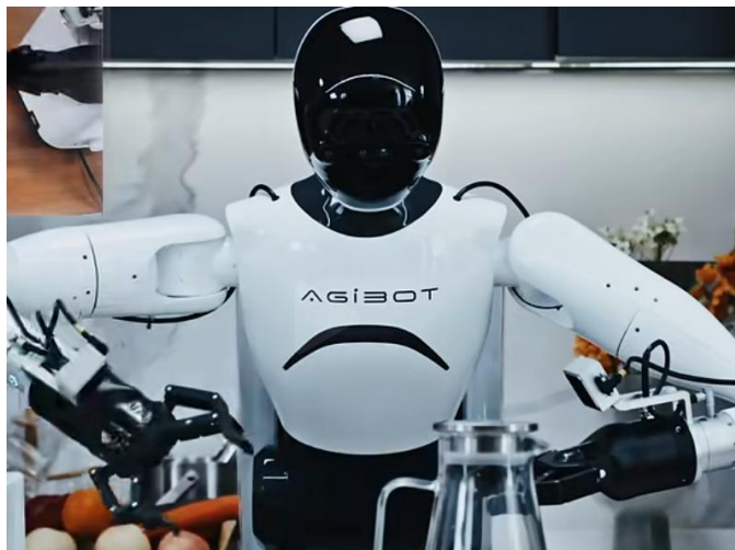
图：G1智元专业数采机器人选用夹爪方案
