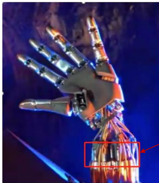
图：特斯拉第二代灵巧手使用微型滚珠丝杠替代蜗轮蜗杆
