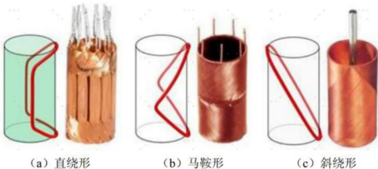
图：空心杯电机的三种绕线结构
