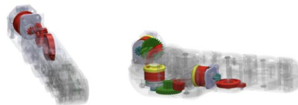
图：灵巧手蜗轮蜗杆传动原理
