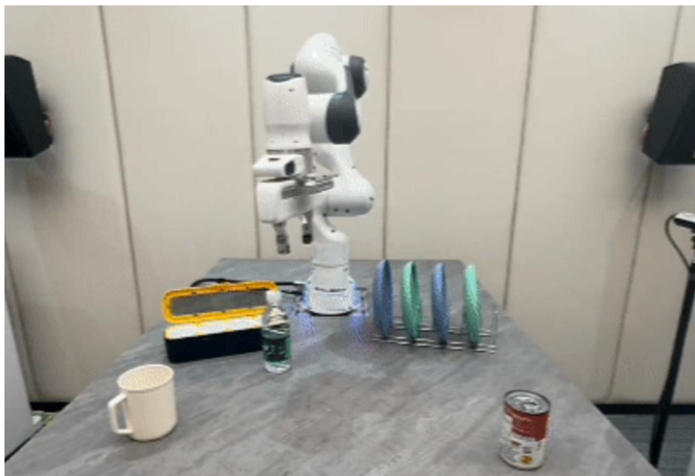
图：银河通用采用二指夹爪训练GraspVLA模型
