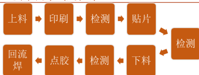
图 25: SMT 电子装联生产线主要工序
