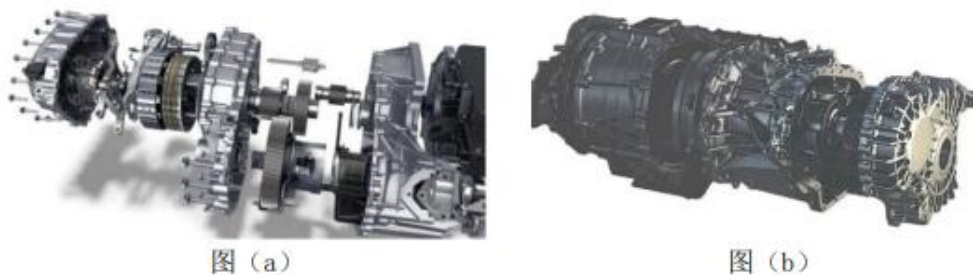
图14：纯电动汽车两挡变速器
