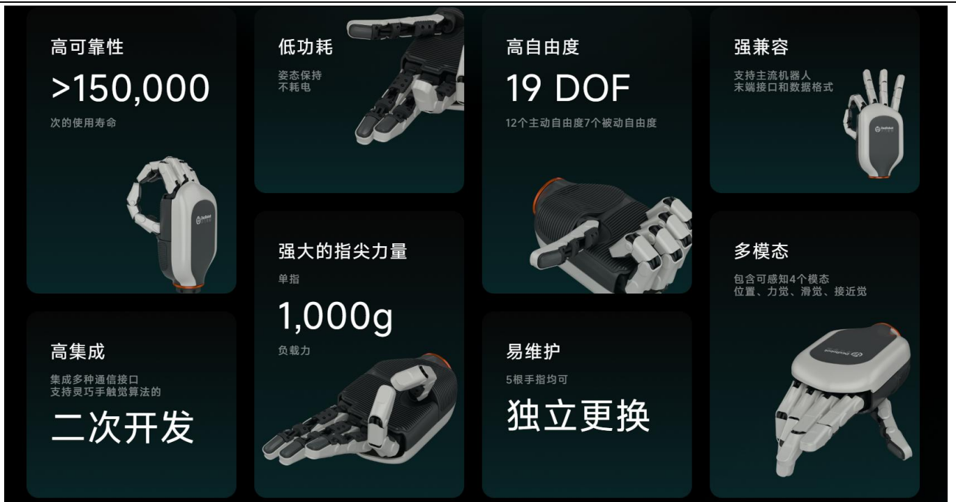
图 1：灵巧智能：Dexhand 021 量产版核心亮点介绍，具有 19 个自由度
