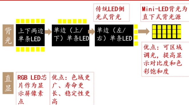
图 18：Mini-LED 分为直显和背光两种路径
