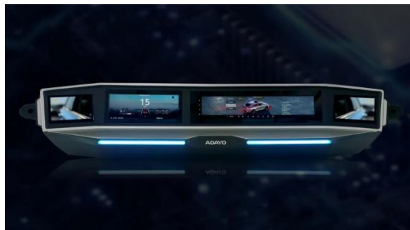
图17: 华阳基于高通骁龙 8255 芯片平台的新一代域控解决方案
