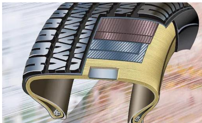
图20: 涤纶工业丝在轮胎中的应用
