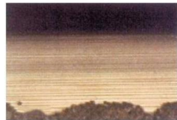
(c) 具有参考平面硅片用3000#细的磨轮进行最终边缘倒角精细磨削加工
