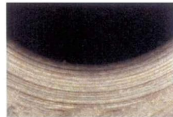
(d) 具有V型槽的硅片用800#粗的磨轮进行边缘倒角磨削加工
