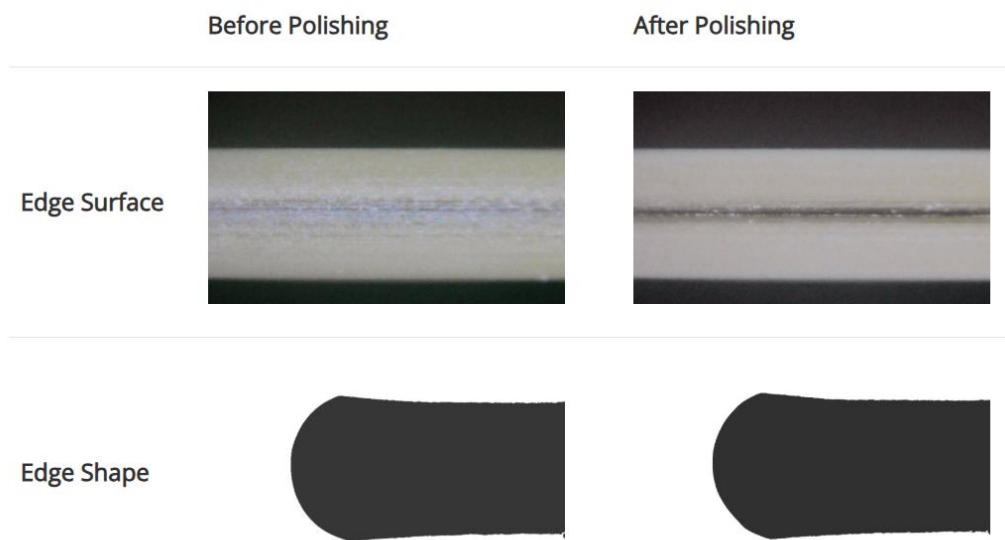
图：边缘抛光后边缘平整度更好，且边缘形状未有变化
