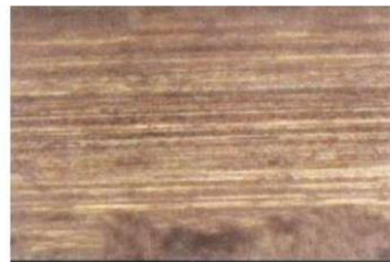
(a) 具有参考平面硅片用800#粗的磨轮进行边缘倒角磨削加工
