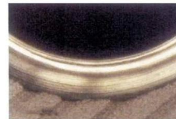
(f) 具有V型槽的硅片用4000#细的磨轮进行边缘倒角磨削加工
