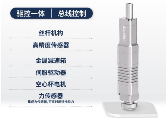
图22：特斯拉机器人灵巧手使用微型丝杠
