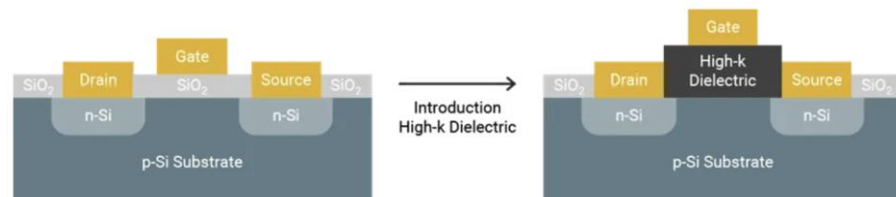
图 45：栅介质层需 ALD 工艺保证厚度为原子级别的精确控制及高覆盖率和薄膜均匀性
