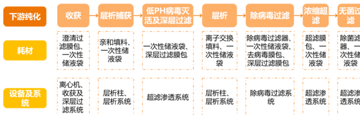
图15：生物药生产下游分离纯化流程
