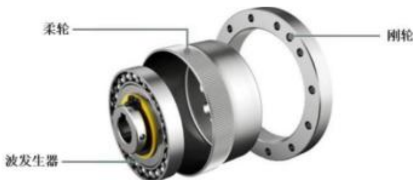
图18: 谐波减速器结构示意图
