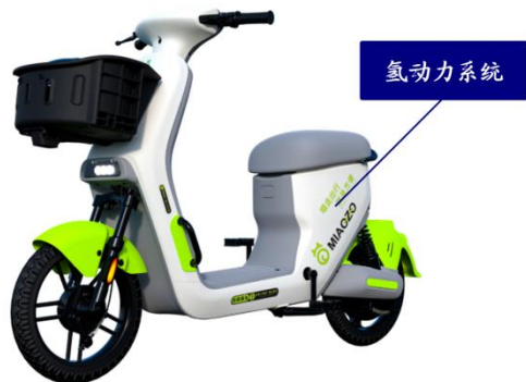
图1：氢能两轮车以氢燃料电池为动力源
