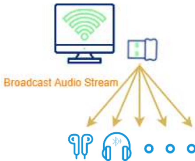
图表14: Broadcast Audio Stream工作模式
