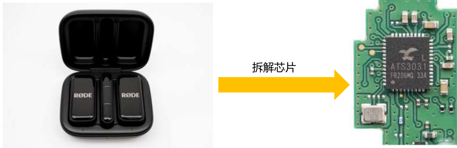
图表18：RØDE罗德Wireless Micro无线麦克风内置炬芯科技ATS3031芯片
