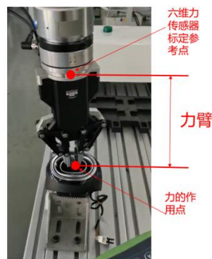
图7: 六维力传感器在机器人末端的应用
