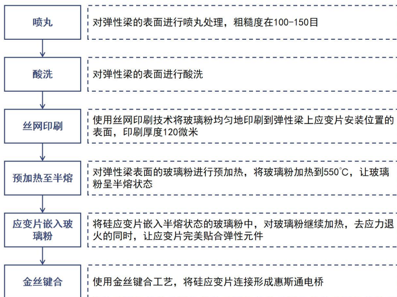
图35：硅基应变片玻璃微熔工艺制备方法
