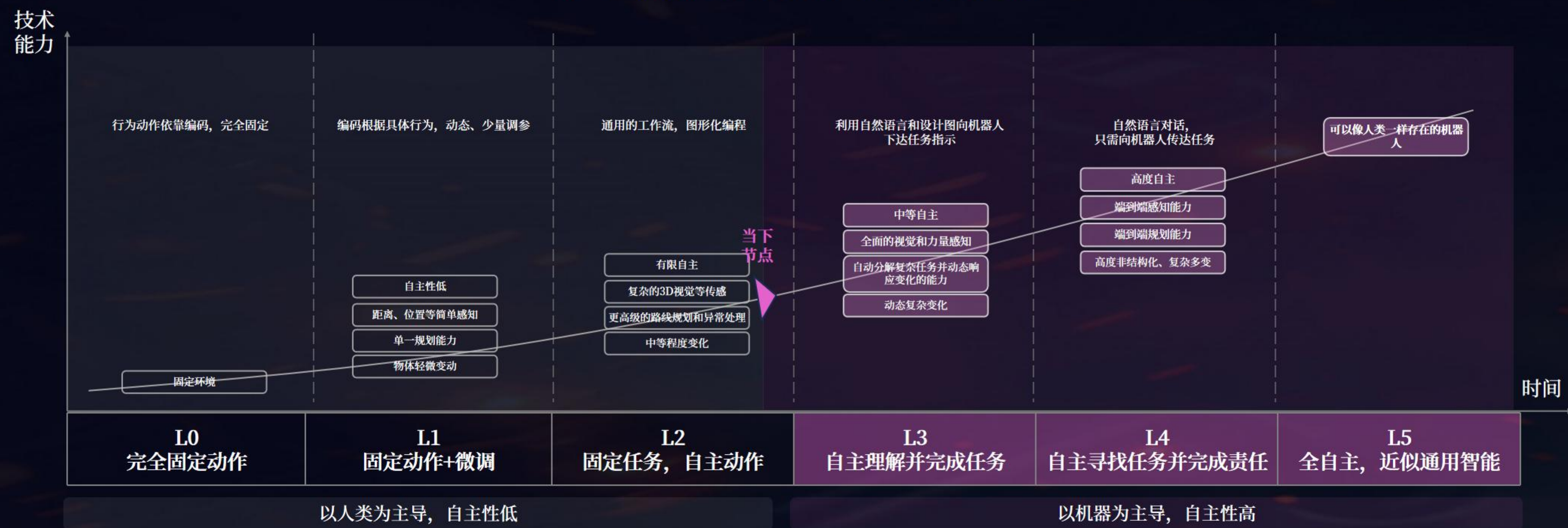
图：通用机器人的等级划分与技术演进路线图
