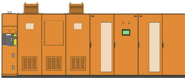
进线柜 + 变压器柜 + 整流输出柜 1 + 整流输出柜 2
