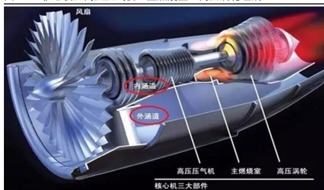
图 37: 核心机由高压压气机、主燃烧室、高压涡轮组成
