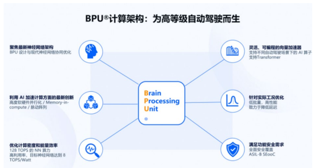
图 33：针对高等级自动驾驶而设计的 BPU 架构
