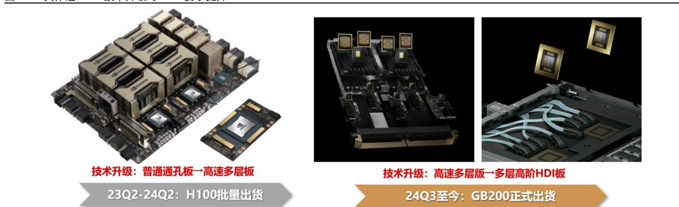
图 21：英伟达 GPU 技术升级对 PCB 要求提升
