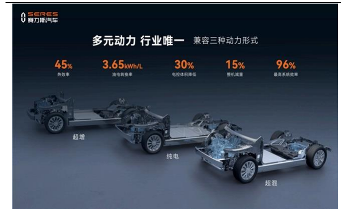
图40：魔方平台可兼容超增、纯电、超混三种动力形式
