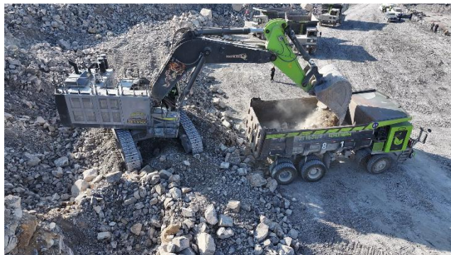
图45：中联矿山设备主要应用于露天煤矿以及金属矿
