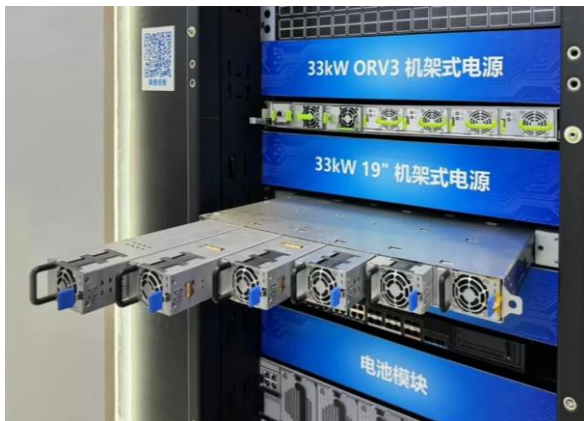
图16: 台达 ORV3 架构的机架式电源
