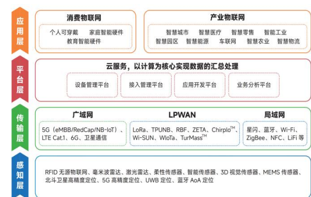
图12：物联网体系架构-应用层、平台层、传输层、感知层
