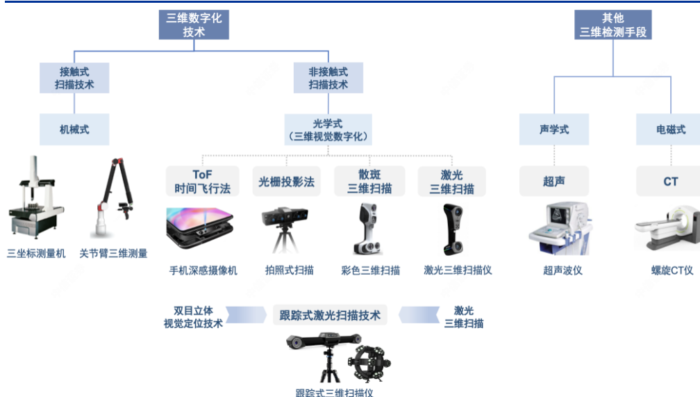
图 26：以非接触式替换传统接触式扫描
