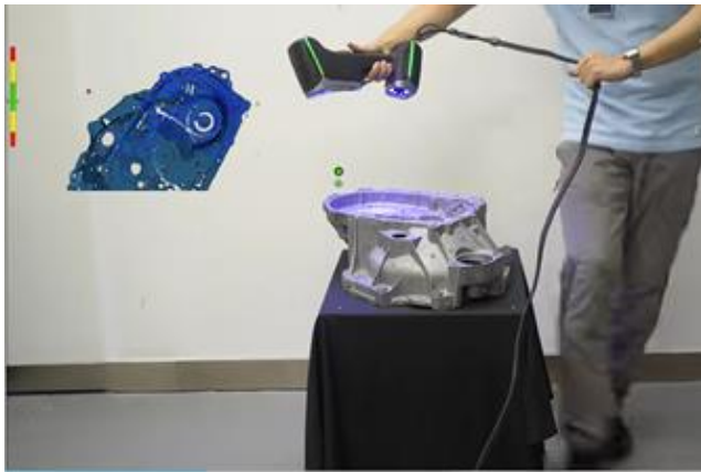
图 2：通过扫描完成零部件的 3D 建模
