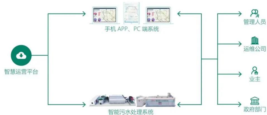
图8：环境监测数据与污水处理设备联动控制模型
