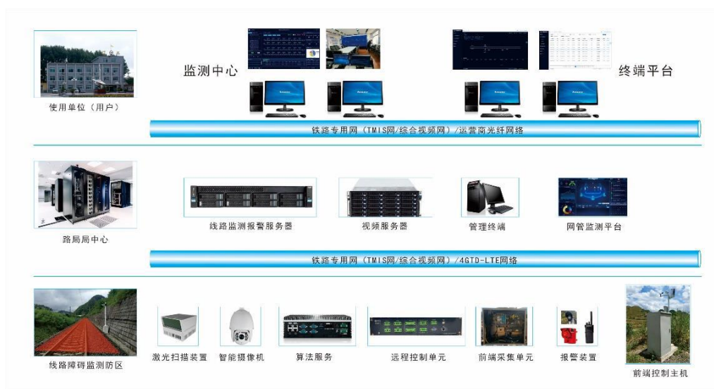
图5：线路监测系统可有效监测影响铁路行车安全的入侵目标
