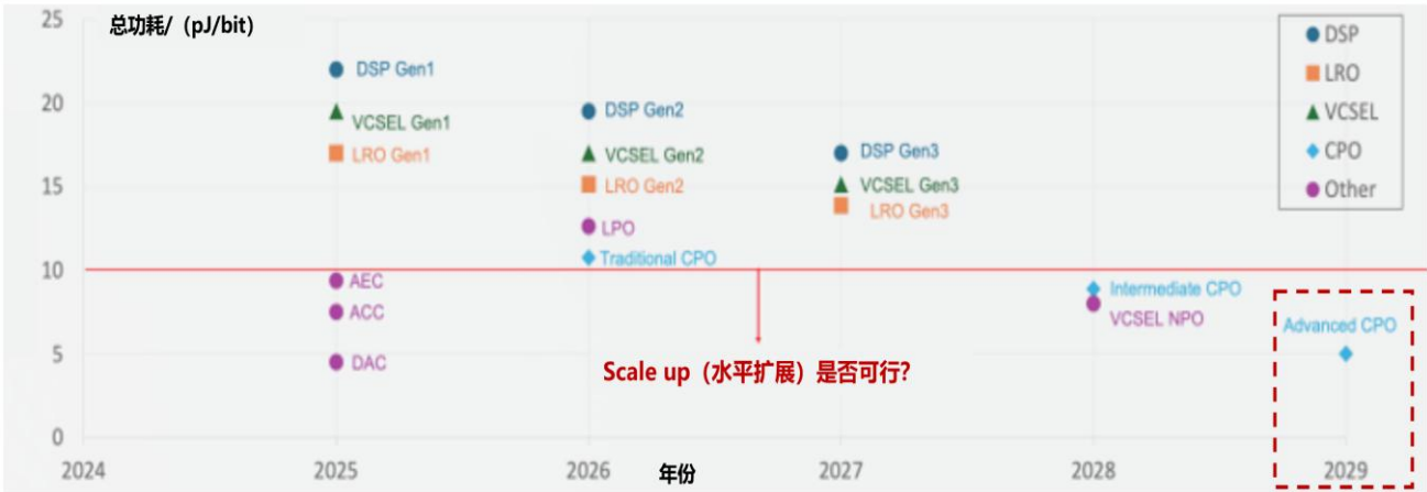
图4：博通认为：预计 2029 年高阶（先进）CPO 会成为数据中心高速通信的主流方案
