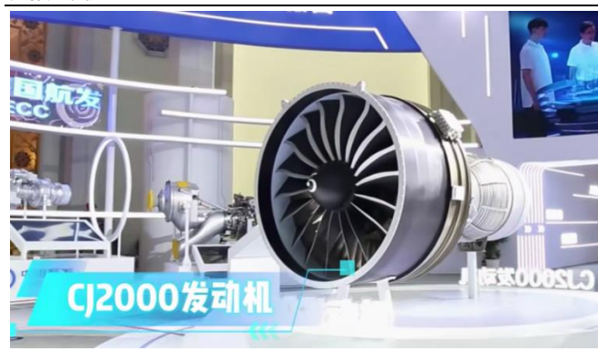
图 35：CJ2000 发动机是以配装双通道远程宽体客机为目标的大涵道比涡扇发动机
