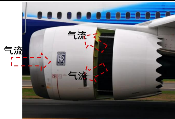
图 30：反推装置工作时发动机内的气流走向
