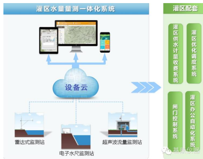
图11：公司灌区信息化监控解决方案可对闸门状态等数据实现远程监管控制
