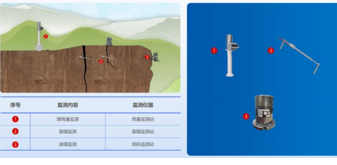
图22：公司崩塌监测系统监测内容包括裂缝监测等
