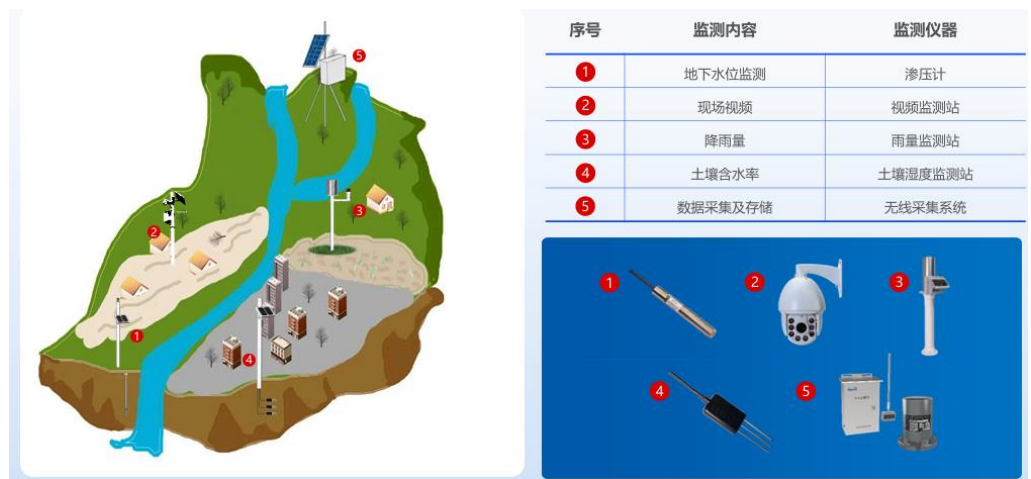
图18：公司山洪灾害监测系统可对地下水位、降雨量、土壤含水量等指标进行监测
