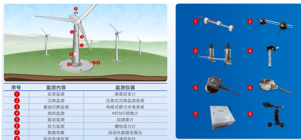
图14：公司风电机组监测系统可应用于海上风电、陆地风电安全监测
