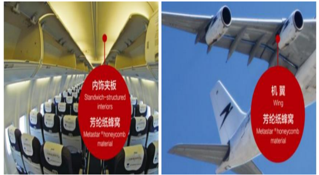
图22：芳纶纸蜂窝应用于内饰夹板、机翼
