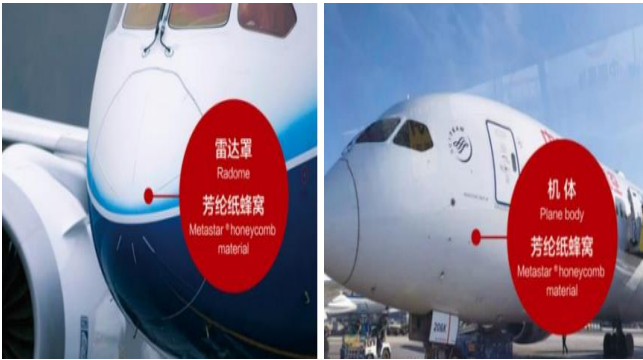
图21：芳纶纸蜂窝应用于雷达罩、机体等结构件
