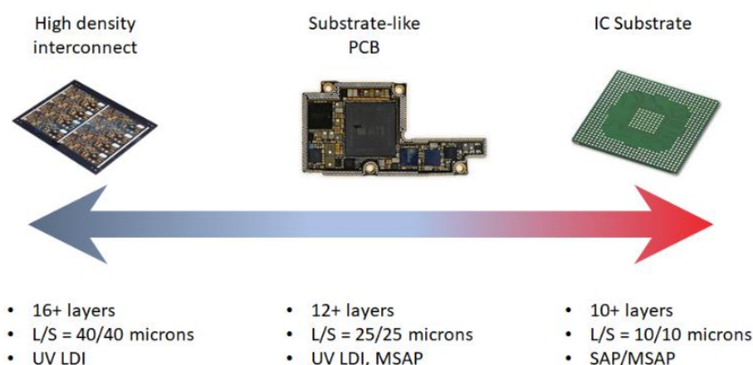
图20、SLP 线宽线距介于 HDI 和 IC 载板之间
