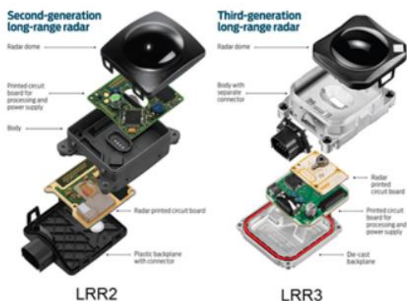
图29、博世毫米波雷达结构
