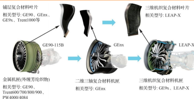
图 16：典型大涵道比航空发动机风扇机匣和叶片复合材料的应用
