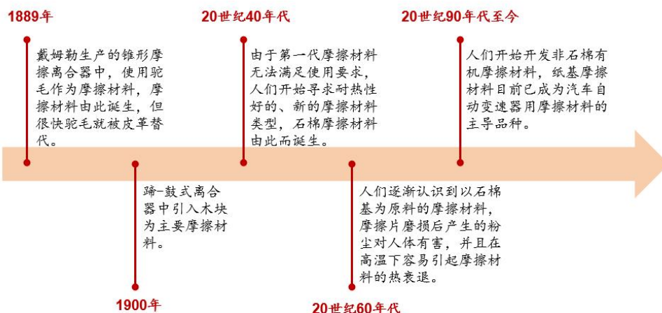
图表 7：纸基摩擦材料目前已成为汽车自动变速器用摩擦材料的主导品种
