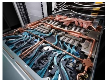
图 16：overpass 分电源（红）和板外飞线（蓝）
