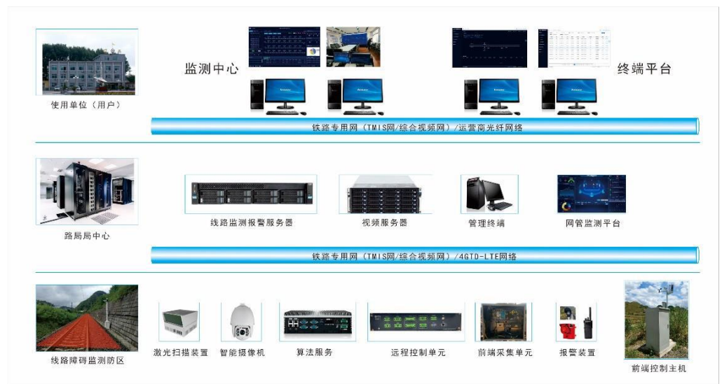
图5：线路监测系统可有效监测影响铁路行车安全的入侵目标
