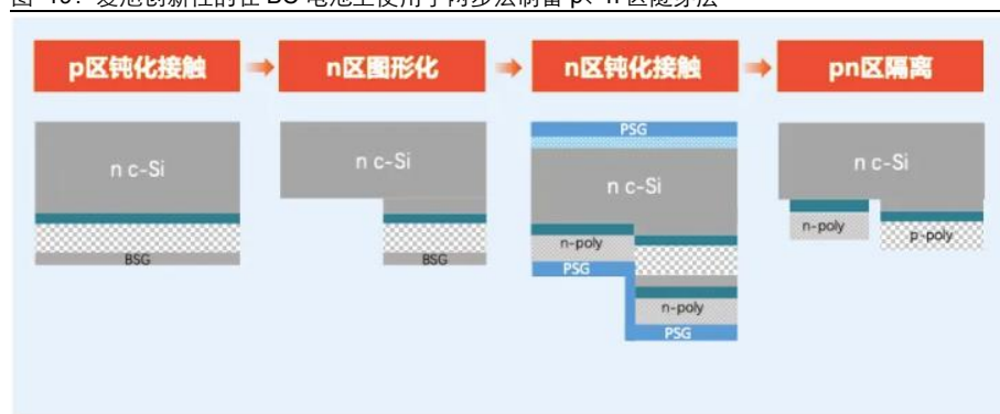
图 19：爱旭创新性的在 BC 电池上使用了两步法制备 p、n 区隧穿层
