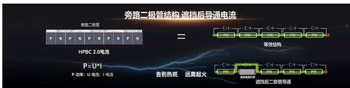
图 10：BC 组件类旁路二极管结构可避免阴影遮挡带来的隐患
