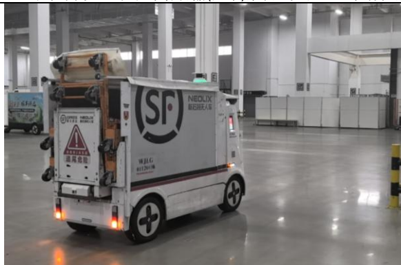
图 19: 顺丰采用无人物流车将容器(笼车)集装直接发运至末端收派区
